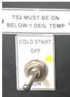
Sinkt die Umgebungstemperatur unter 0°Celsius und der Motorvorwärmungs-Hauptschalter ist auf ON, so wird der Motor vor dem Starten 2 Minuten lang vorgewärmt. Während diesem Vorgang leuchtet die rote Kontrollleuchte auf dem Schaltpanel.
