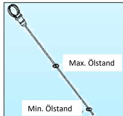
**HINWEIS:** Prüfen Sie den Ölstand nicht bei laufendem Motor. Stellen Sie den Motor ab, warten Sie 10 Minuten, und prüfen Sie dann den Ölstand.
