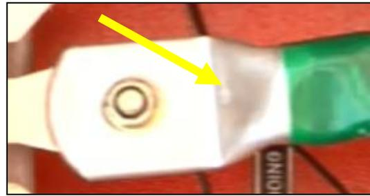
Verwenden Sie ein Isolierband für die gekrimpten Kabel.
